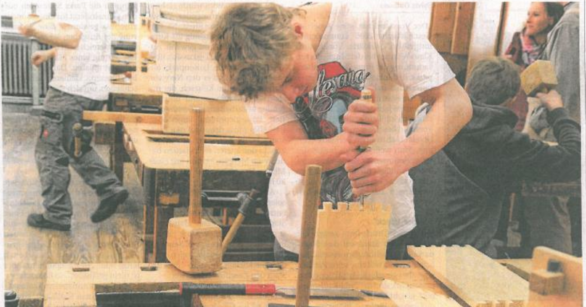
Schreiner-Lehrling Ramon Martini zeigt in der Werkstatt der Heinrich-Lanz-Schule, wie genau beim Zinken gearbeitet werden muss.
